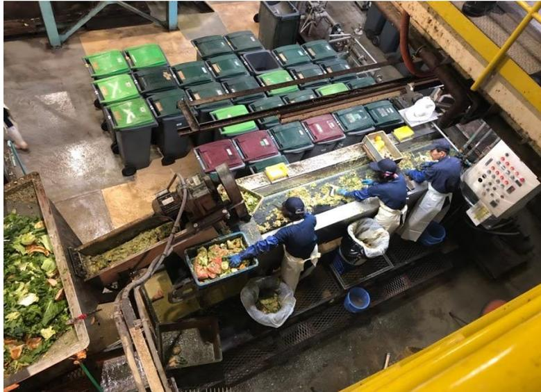
(写真2 原料選別中の写真 筆者撮影 上に見るのが回収容器)
